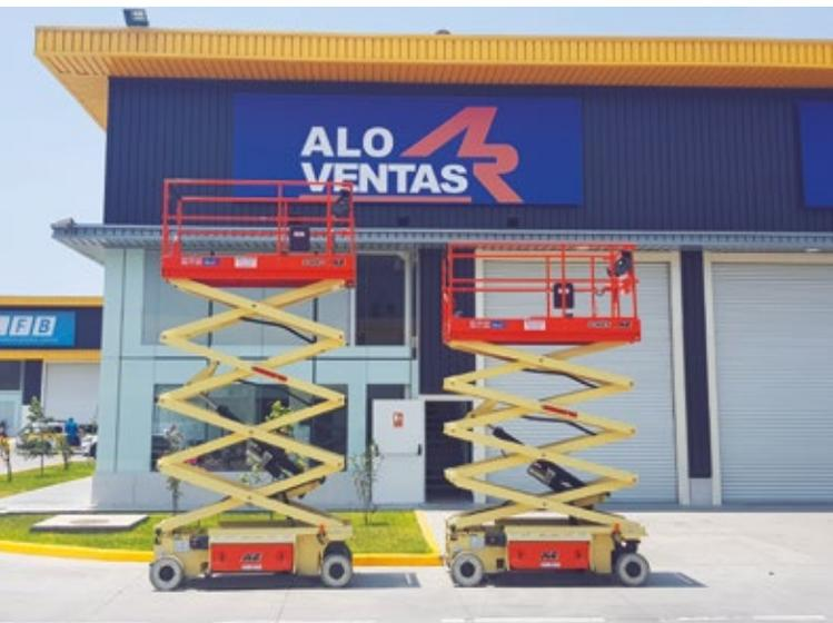
Estos equipos cuentan con sensores de peso, los cuales advierten al operador de un posible exceso de peso en la canastilla.
