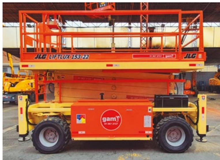
Todos los equipos de elevación cuentan con una bajada de emergencia en caso de cualquier fallo del motor.
